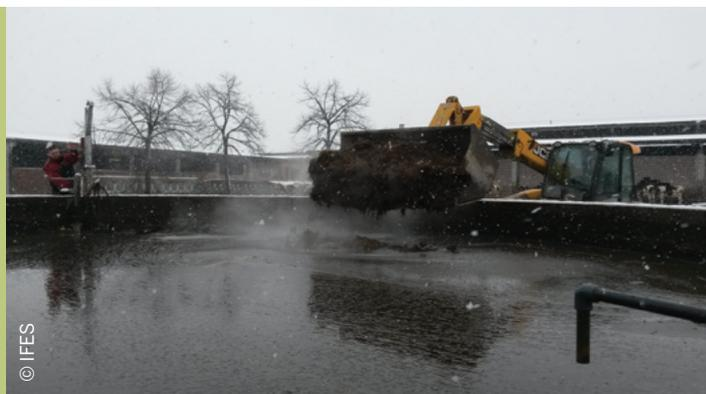
**Imagen 23.** Sistema de precarga de biodigestores con diferentes sustratos sólidos y líquidos
