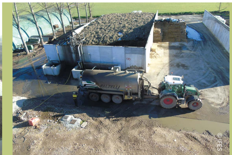
Imagen 15. Segregación de fracciones líquida y sólida con separador helicoidal. Almacenamiento de la sólida
