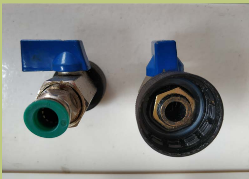
Imagen 35. Llavín de paso de gas para digestor batch de laboratorio
