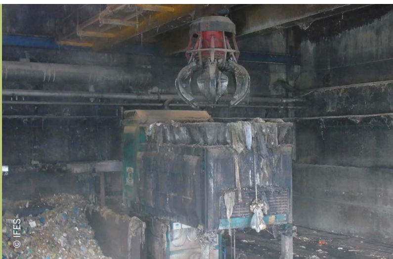
Imagen 24. Sistema de limpieza de FORSU, pretratamiento para envío del sustrato a tanque de precarga
